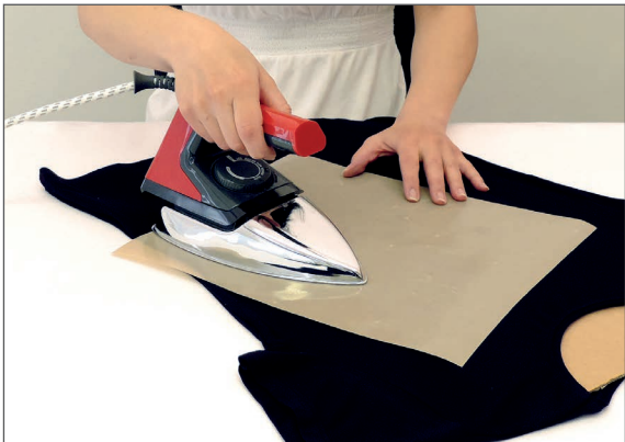
3 熨烫过程中，应使用铁氟龙衬垫覆盖烫石，避免熨斗表面沾染黏胶。
