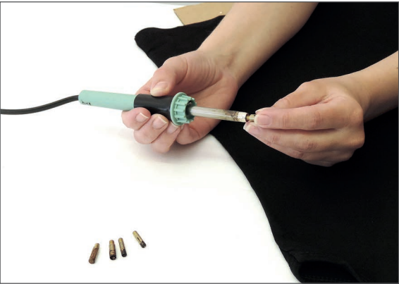
1 选择与烫石尺寸对应的吸嘴，安装在点钻机上
