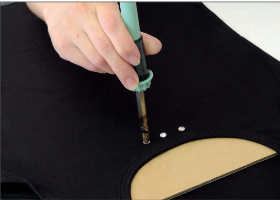
3 将布料放置在合适的垫板（玻璃、陶瓷、金属）上，然后向烫石施加压力。
