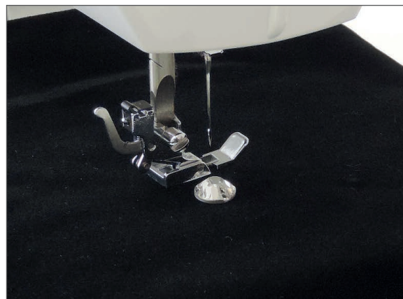
缝纫手缝石时需要将下定针关上。
