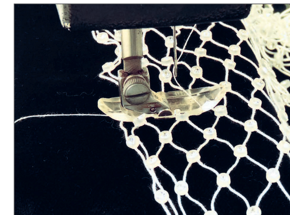
根据需要缝合的产品使用窄拉链压脚。
